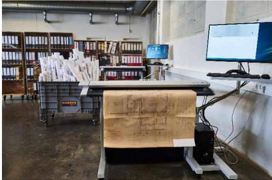
*Bildunterschrift: Planscanner, geeignet für Formate bis über DIN A0, kommen beispielsweise bei Bauplänen zum Einsatz.*
