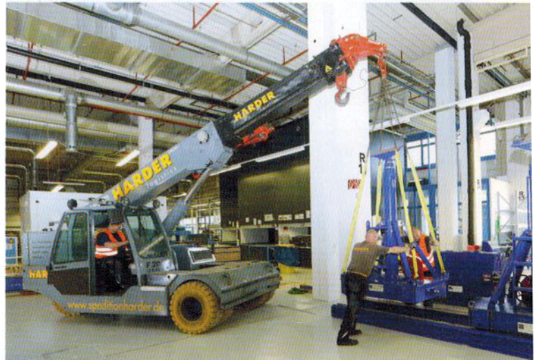
Für das Handling und den Transport sperriger Anlagenteile kommt ein Elektro-Mobilkran zum Einsatz
